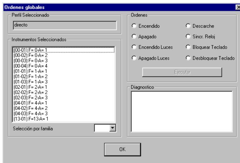
La ventana está dividida en dos secciones; la de la izquierda muestra la lista de dispositivos conectados al perfil seleccionado.
