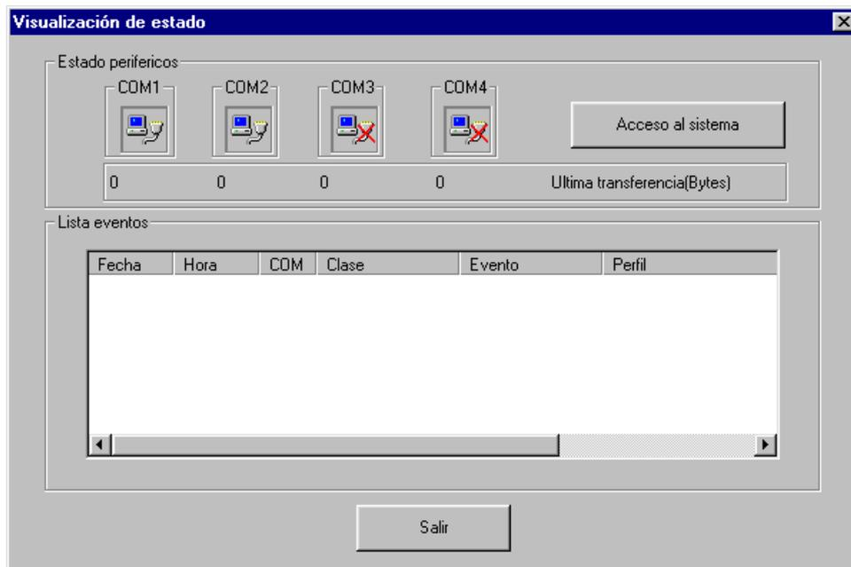
La ventana contiene tres secciones operativas: una serie de iconos que representa el estado de los puertos del sistema, la tecla "Acceso al Sistema" que permite entrar en el sistema, y la tecla "Salir", que permite salir del sistema.
