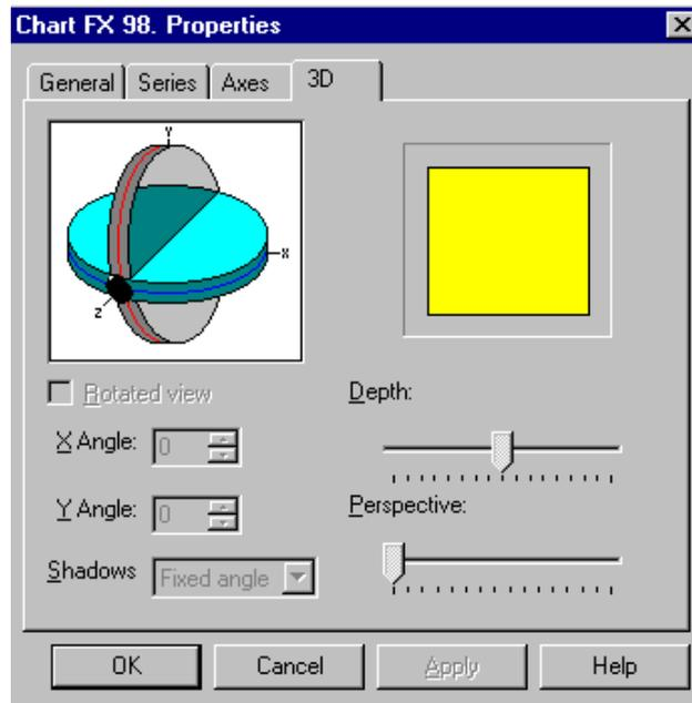
Esta pantalla permite seleccionar algunos parámetros para visualizar los gráficos en 3 dimensiones: rotación del eje, tipo de sombra, profundidad y perspectiva.
