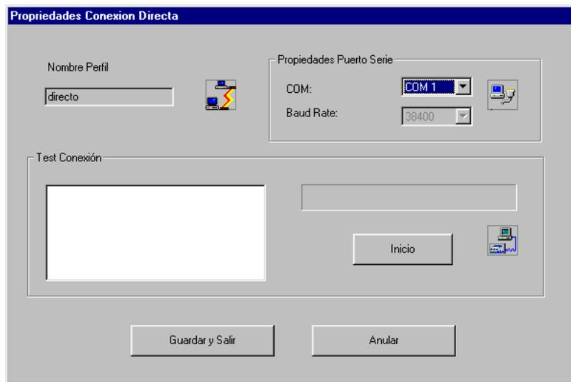
La información que se pide es necesaria para comenzar la conexión directa: el puerto de serie al que se conecta directamente el **TelevisCompact**, y la velocidad en baudios propuesta es la usada normalmente para este tipo de comunicación.
