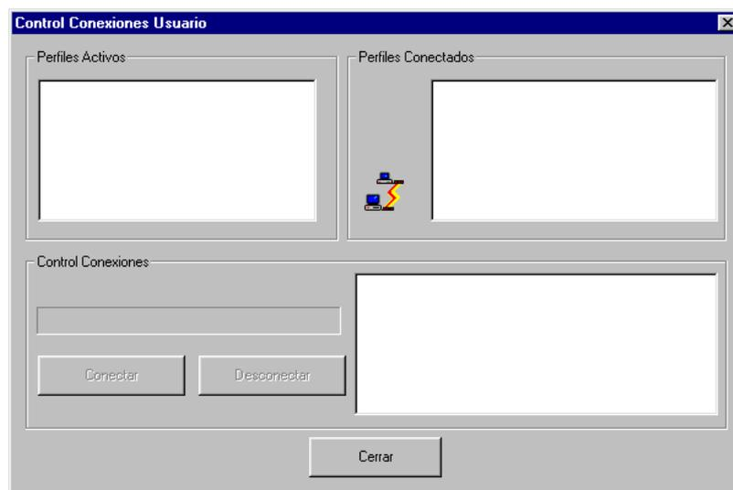
La ventana de Control Conexiones del Usuario propone dos listas de perfiles; en la lista de la derecha están los Perfiles de Usuario ya conectados. En la lista de la izquierda los perfiles de Usuario no conectados pero habilitados para poder conectarse.
