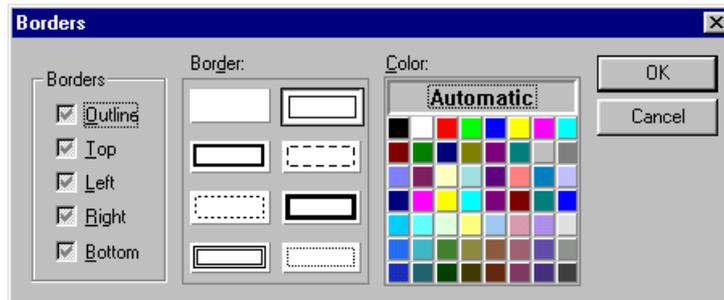
Las tres secciones de la ventana permiten cambiar los bordes (Bordes: borde exterior, arriba, izquierda, derecho, inferior), el tipo de línea que rodea la celda (Borde) y el color del borde (Color).
