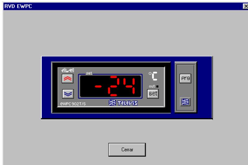
No sólo podemos interactuar con el dispositivo en la pantalla RVD, también podemos tener bajo control la situación -alarmas, descarches y salidas- observando los Leds correspondientes y leyendo el valor de las sondas.
