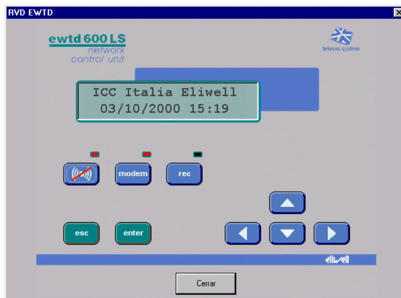
Podemos utilizar todas las teclas del instrumento como si estuviéramos trabajando con el aparato real. Veamos otro ejemplo de dispositivo visualizado en el modo RVD:
