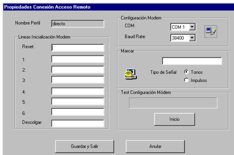
Los datos introducidos son los necesarios para empezar la conexión de Acceso Remoto. Se trata concretamente del puerto de serie al que se conecta el módem, de la velocidad en baudios seleccionada para la comunicación (baud rate), del número al que ha de llamarse para conectar con el Televis**Compact** y del tipo de señal (tonos/impulsos) que utiliza la línea telefónica.
