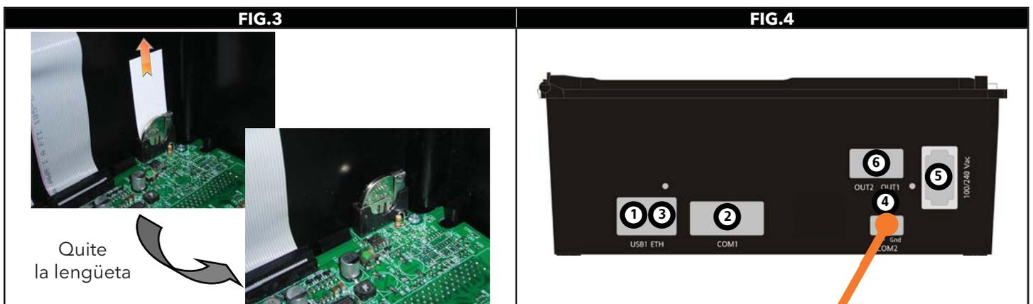
**ATENCIÓN:** preste especial atención al conectar el positivo (+), el negativo (-) y la masa (GND) de la RS485 al dispositivo. (ver esquema de al lado)
