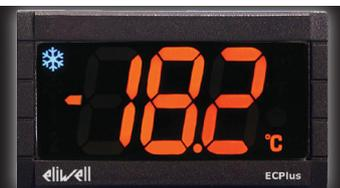
Display para visualizar remotamente el valor del punto de intervención (Setpoint) o el valor de las sondas de regulación y el correspondiente estado de error de los controles para muebles frigoríficos remotos y plug-in.
