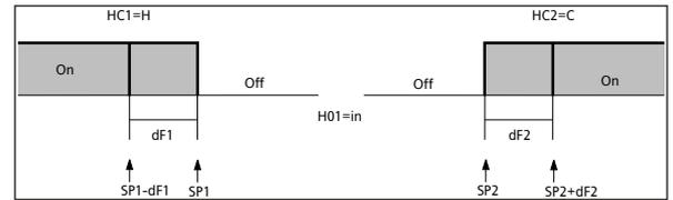
esquema de regulación ON-OFF independiente. Las dos salidas regulan como si fueran completamente independientes **1**
