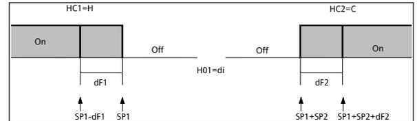
esquema de regulación ON-OFF dependiente. El punto de intervención 2 SP2 regula en base a SP1 **2**
