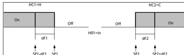
esquema de regulación ON-OFF independiente. Las dos salidas regulan como si fueran completamente independientes
