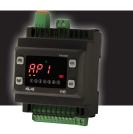
Control con parámetros para la adquisición de variables de la instalación en tiempo real y para la señalización de estados de alarma cuando están conectados a un sistema de supervisión ya sea éste específico (Televis) o estándar del mercado (protocolo MODBUS).
