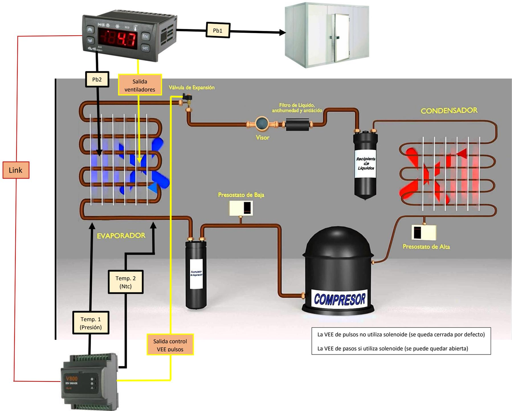
La VEE de pulsos no utiliza solenoide (se queda cerrada por defecto)
