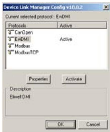
Para **Smart** seleccione **EWDMI** o **Modbus**<sup>[2]</sup>. Si el protocolo no está activado pulse la tecla **Activate**
