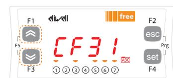
Con las teclas UP y DOWN desplácese a los otros parámetros y repita el procedimiento para visualizar los valores y - si es necesario - modificarlos
