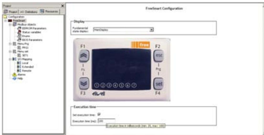
Mediante el menú desplegable se puede configurar el valor de la variable / parámetro que se pretende visualizar en el instrumento **FREE Smart** como visualización principal (**Fundamental state display**). Si no selecciona ningún valor (**none**) el instrumento visualizará **PLC**.
