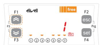
Utilice las teclas UP y DOWN para modificar el valor si es necesario. Para confirmar el valor pulse la tecla set. Para salir pulse esc
